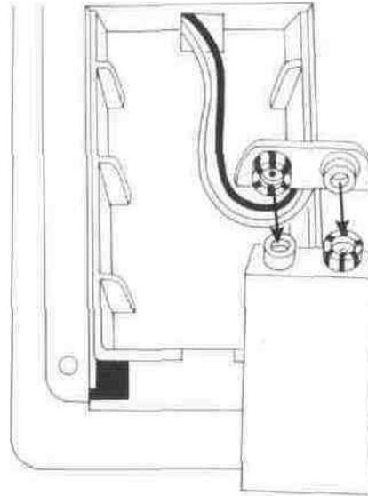
Der Einbau der Batterie ist einfach. Der Deckel an der Unterseite des Computers wird in Pfeilrichtung weggeschoben; dabei leicht drücken, um die Sperre zu überwinden.
