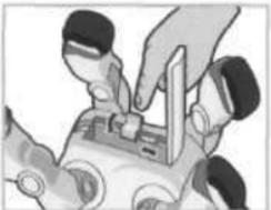
4. Schiebe die verbundenen Kabel in das Fach und schliesse den Batteriefachdeckel.
